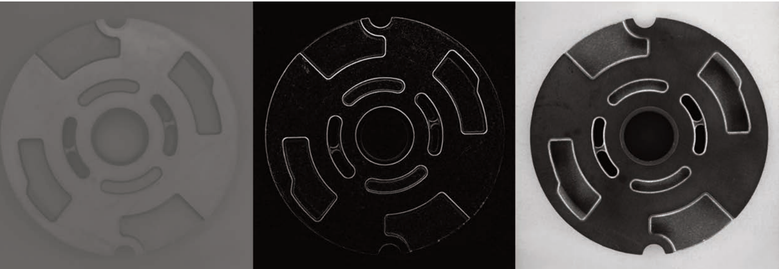
Bildvorverarbeitung wird häufig mit Softwarewerkzeugen durchgeführt. Es bestehen aber auch andere Möglichkeiten Bildvorverarbeitung durchzuführen, wie z.B. durch das gezielte Ausnutzen von Beleuchtungstechniken. Linkes Bild: Schlecht kontrastiertes Bild bei der Bildaufnahme. Mittleres Bild: Mit Softwaretools (Kontrastspreizung und Kantenfilter) hervorgehobene Kanten. Rechtes Bild: Durch Dunkelfeldbeleuchtung hervorgehobene Kanten.
