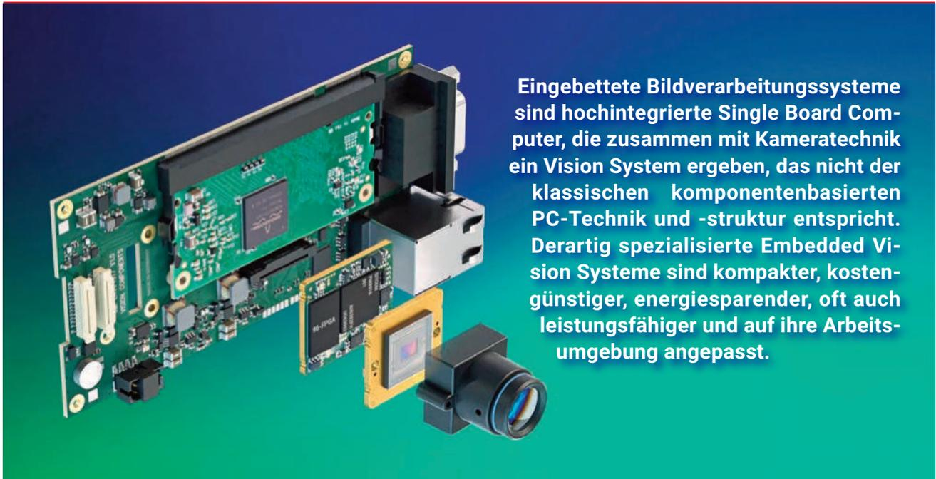
**Eingebettete Bildverarbeitungssysteme sind hochintegrierte Single Board Computer, die zusammen mit Kameratechnik ein Vision System ergeben, das nicht der klassischen komponentenbasierten PC-Technik und -struktur entspricht. Derartig spezialisierte Embedded Vision Systeme sind kompakter, kostengünstiger, energiesparender, oft auch leistungsfähiger und auf ihre Arbeitsumgebung angepasst.**
