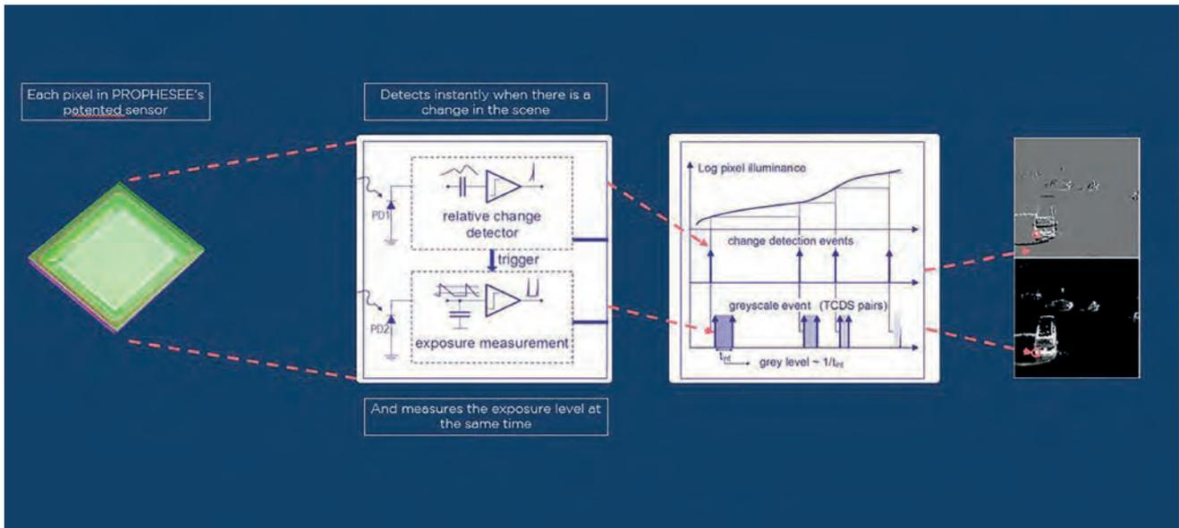
**Die Wirkungsweise von Event Based Cameras wurde von der menschlichen Bildwahrnehmung abgeleitet, bei der Aktionen dann ausgelöst werden, wenn sich im Bildfeld des Betrachters etwas ändert. Dazu benötigen die Kameras einen speziellen Bildsensor (Event Based Vision Sensor, EVS). Dieser liefert nur Daten von Pixeln, deren Intensität (monochrom oder Farbe) sich aktuell geändert hat.**
