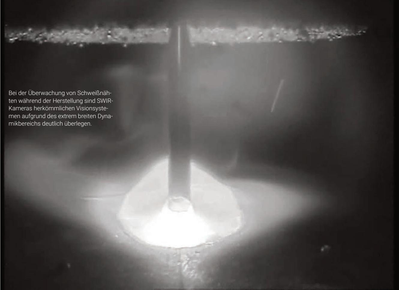
Bei der Überwachung von Schweißnähten während der Herstellung sind SWIR-Kameras herkömmlichen Visionsystemen aufgrund des extrem breiten Dynamikbereichs deutlich überlegen.
