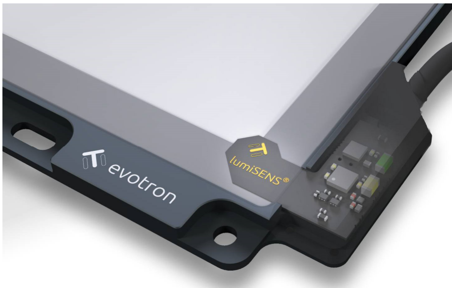
Abbildung 2: Der Light-Sensor-Processor ermittelt mit seiner Sensorik kontinuierlich Ist-Werte der Beleuchtung und überträgt diese über das 4-polige M8-Kabel an den Beleuchtungscontroller.
