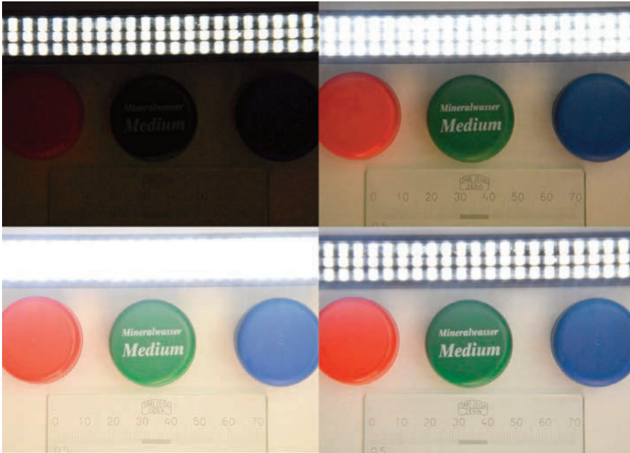
v.l.o.n.r.u.: 1. Unterbelichtetes Bild, 2. Normal belichtetes Bild, 3. Überbelichtetes Bild, 4. HDR-Bild, generiert aus der Bildserie 1. bis 3. Das HDR-Bild verbindet Erkennbarkeit aller LEDs mit Helligkeits- und Farbkontrast.
