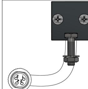
**Variante 1:** Sechskantschrauben M3 in die Profilnut einschieben und mit der Mutter M3 befestigen
