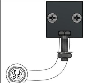
**Variante 1:** Sechskantschrauben M3 in die Profilnut einschieben und mit der Mutter M3 befestigen
