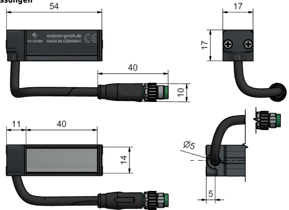
Kabellänge ohne Steckverbinder = 200 mm
